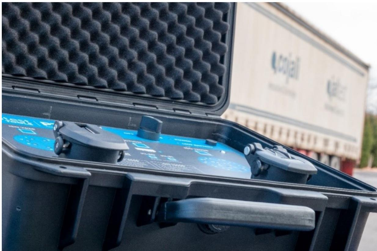
En utilisant Jaltest PTE comme source d'alimentation pour le véhicule tracté et sans avoir besoin d'un tracteur routier, vous pouvez vous connecter à des systèmes à commande électronique avec l'outil de diagnostic Jaltest.
